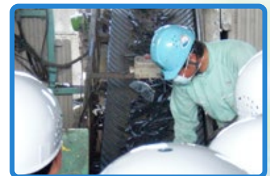
▲タイヤや工業ゴム製品が 破碎され細かくなって出てきます。
