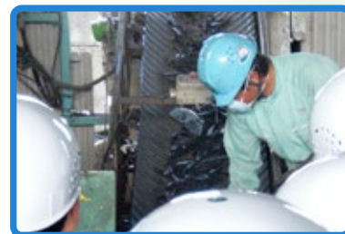
▲タイヤや工業ゴム製品が 破碎され細かくなって出てきます。
