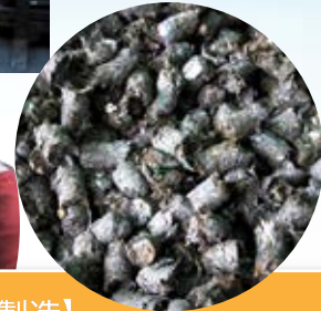
【RPF製造】 紙、プラスチック等のゴミから固形の燃料を作る設備、出来たてのRPFを手にとって見て頂きました。
