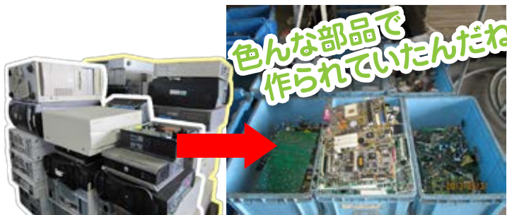
皆さんには、デスクトップの解体作業を中心に体験していただきます。使用されている部品を細かく分けることで、マテリアルリサイクル率がぐ～んと上がります！
